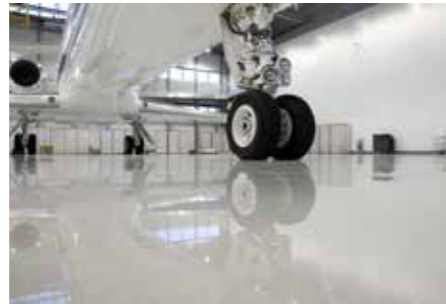
Slät pigmenterad epoxibeläggning: 1,5-3 mm
