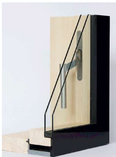
Walch fenster, ett slimmat fenestration i trä och glasfiber med stappat glas för vridbeslag dolda i halvvarm zon. Foto: Stefan Ageter
