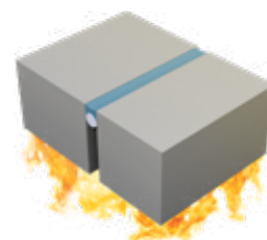
8. Enkel tätning, oexponerad sida
