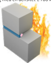
T2. Enkel tätning, oexponerad sida
