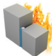
2. Enkel tätning, oexponerad sida
