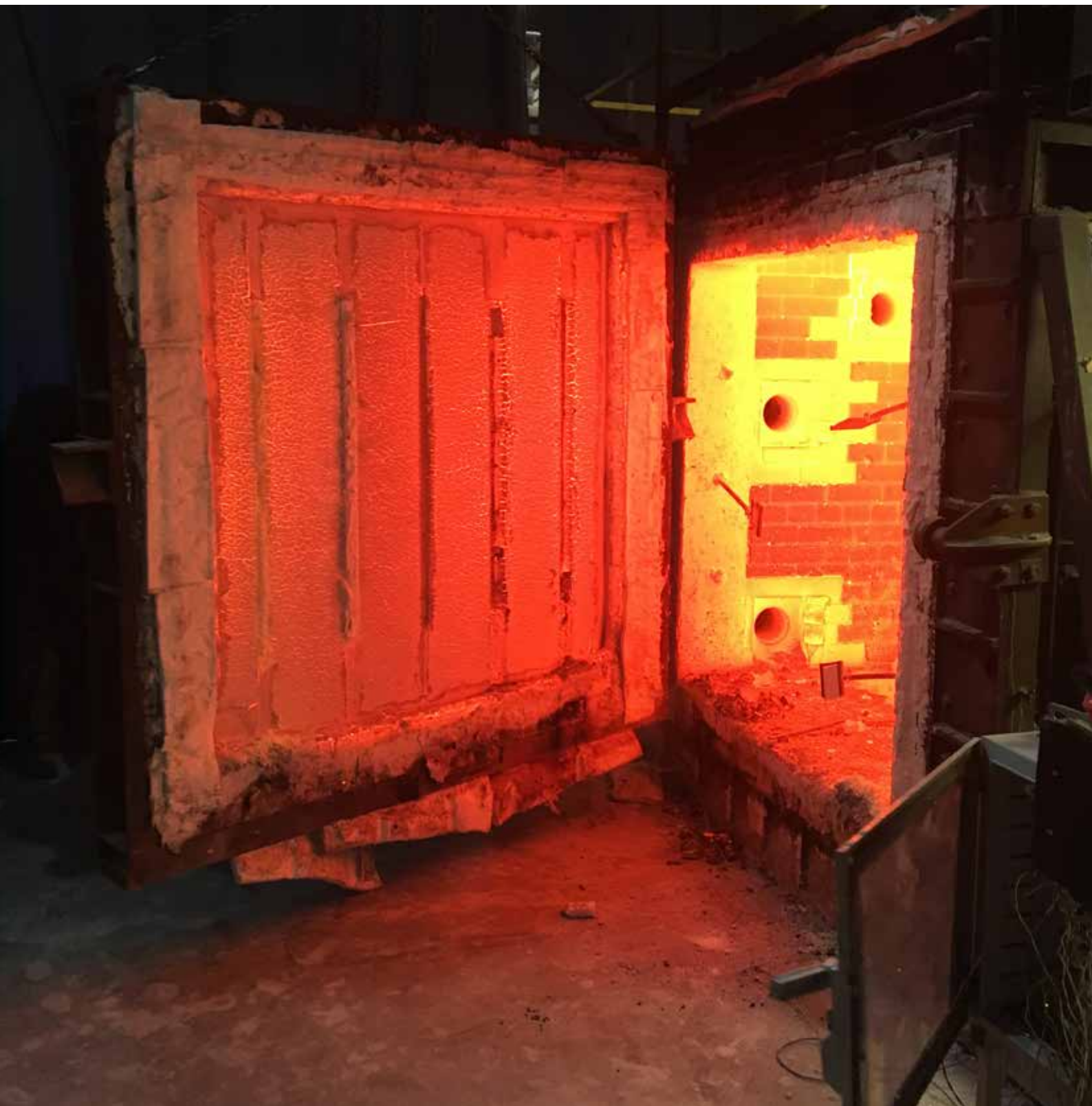
Ugn med vertikala linjära fogar efter brandtest enl. EN 1366-4
