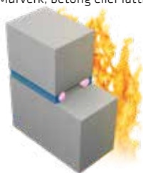
T1. Dubbel tätning
