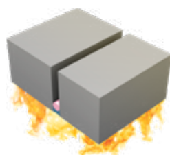
H3. Enkel tätning, exponerad sida och alla positioner inom golvet
