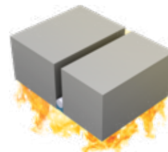
9. Enkel tätning, exponerade sidan
