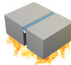
8. Enkel tätning, oexponerad sida
